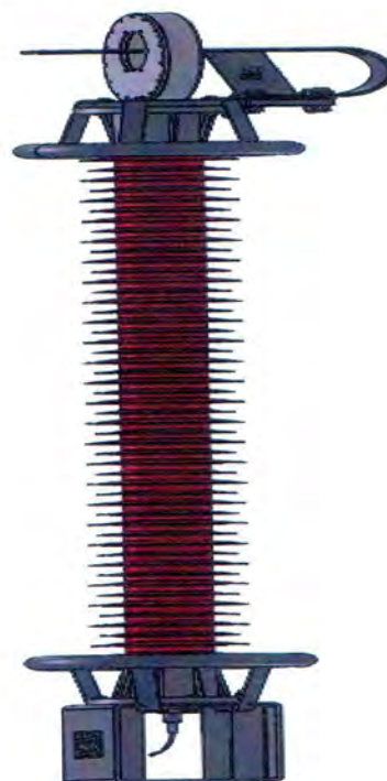
Рисунок 3 – Высоковольтный изолятор с установленным чувствительным элементом ТТЭО-220
