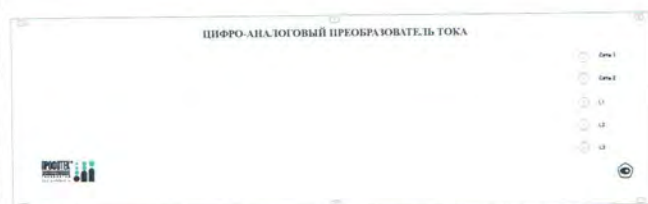
Рисунок 10 – Электронный блок ЦАП Т для вывода пропорционального аналогового сигнала 1А трансформаторов ТТЭО
