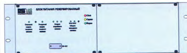
Рисунок 11 – Электронный блок резервированного блока питания повышенной надежности (вид спереди)
